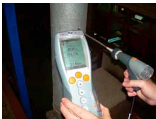
Medición rendimiento combustión en caldera. Cortesía SGS.
