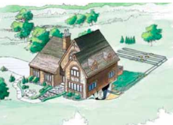
Captadores horizontales – Fuente: Geoexchange
